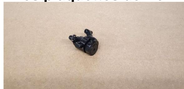
**Le mécanisme de frein (étrier)**
