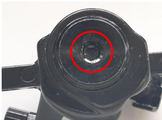
Une fois la plaquette retirée, on peut voir la seconde à travers l'étrier, celle-ci est aimantée à l'étrier.
