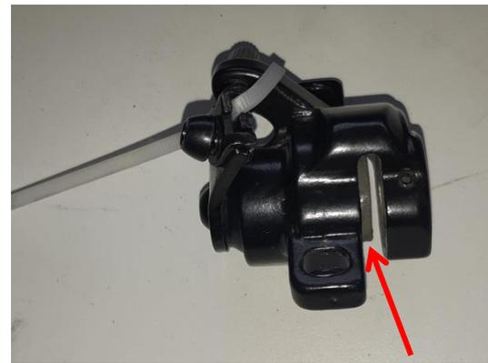
Replacer les nouvelles plaquettes en présentant la première dans son logement aimanté et la seconde en la vissant avec la clé Allen (taille 4).
